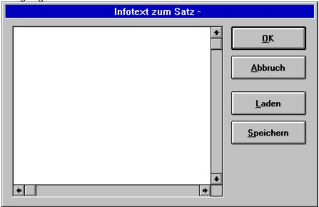
Bei Öffnen der Dialogbox wird diese Datei geladen und kann bearbeitet werden. Nach Beenden des Dialoges wird der Text gespeichert. Mit den Buttons 'Laden' und 'Speichern' kann eine neue Datei gewählt werden.
