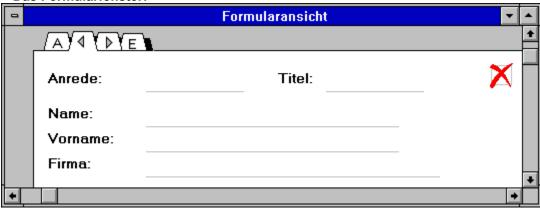
Das Fenster kann mit den Rollbalken über dem Formular verschoben werden. Ein Doppelklick auf den Formularbereich öffnet den Eingabedialog zum Ändern eines Satzes.
